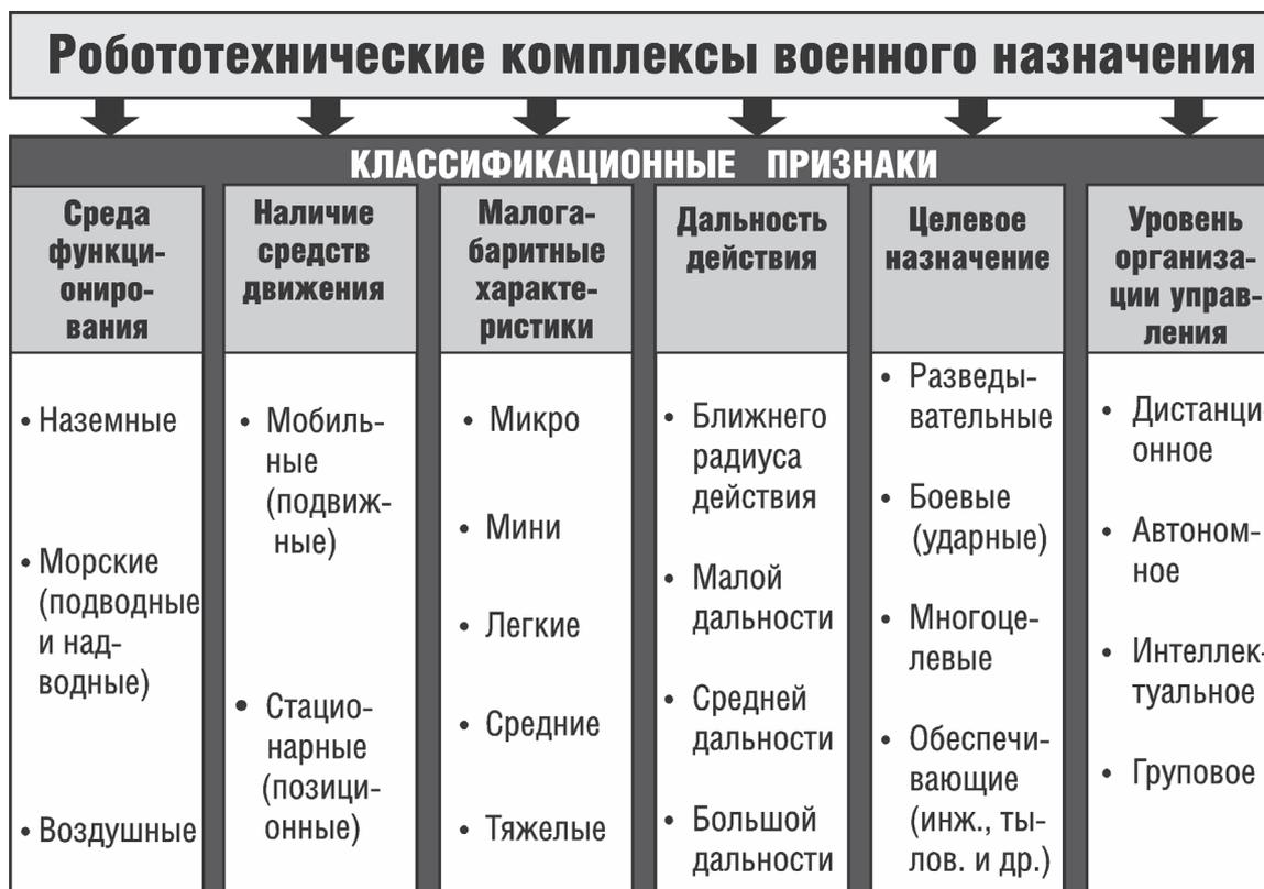
Рис. 1. Классификация робототехнических комплексов военного назначения
