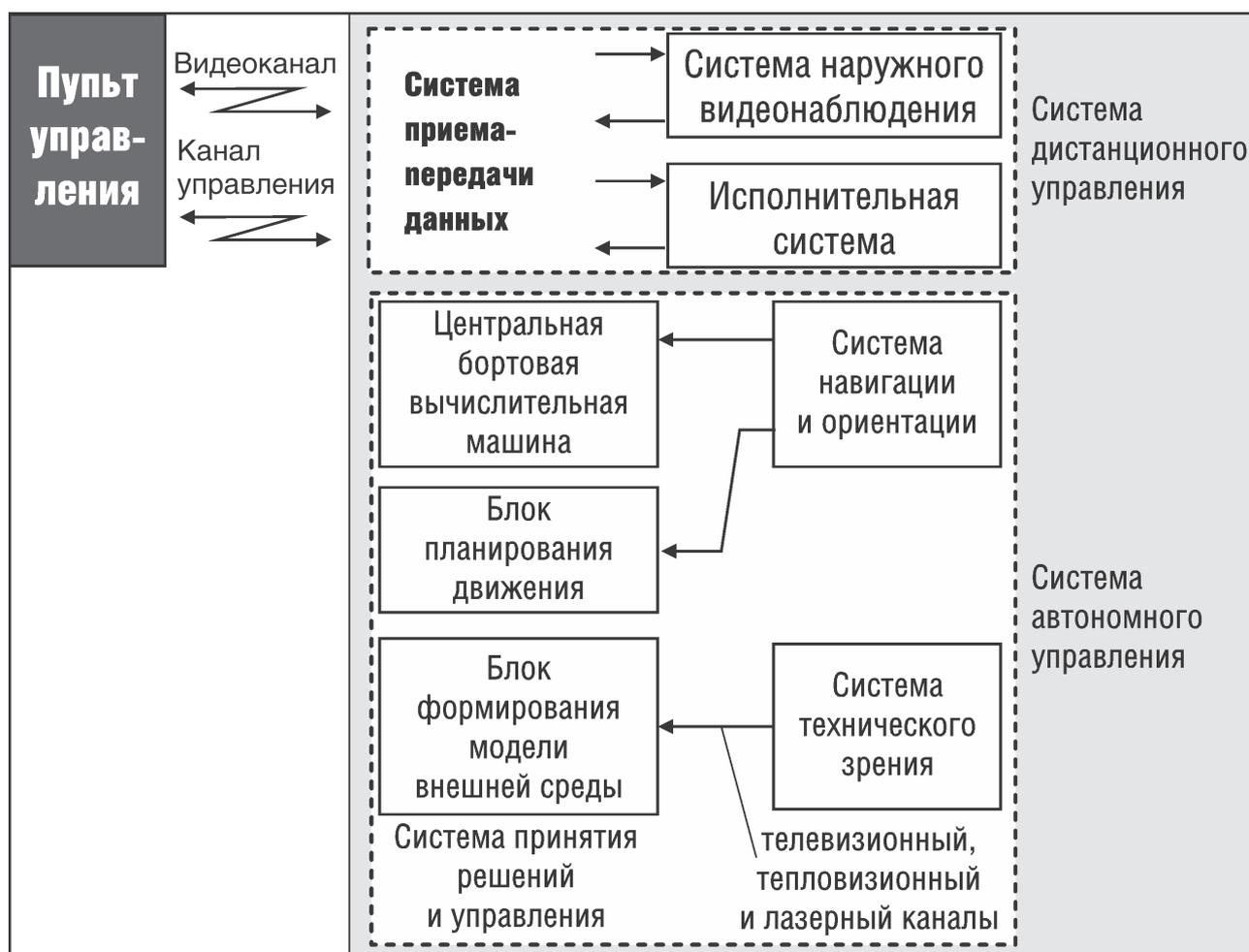
Рис. 2. Обобщенная структурная схема САУД РТК
